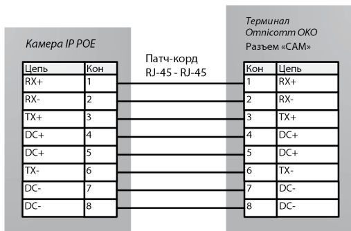
Рисунок 7. Схема подключения видеокамеры
