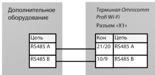
Рисунок 11. Схема подключения оборудования по интерфейсу RS-485
