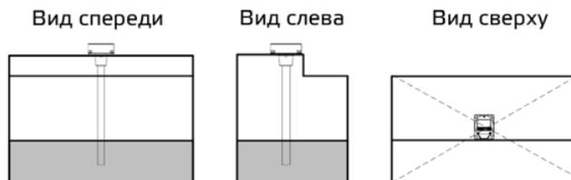
Рисунок 1. Выбор места установки датчика Omnicomm LLS-Ex 5
