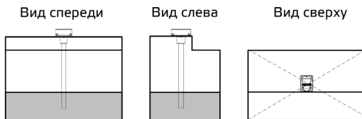
Рисунок 1. Выбор места установки датчика Omnicomm LLS 5
